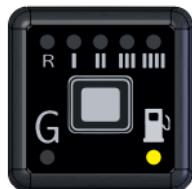
2. Premere il pulsante del commutatore per circa 5 secondi in modo da entrare nella programmazione luminosità dei LED. Tutti i led si accendono con intensità pari all'ultima memorizzata.
